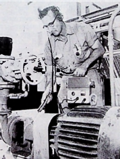
Onderhoudsmonteur doet een meting op het lager van een koelwaterpomp, welke zich in een omgeving met veel agressieve stoffen bevindt, waarvoor wordt gebruik gemaakt van de contact-opnemer in een koptelefoon, teneinde geen hinder te ondervinden van omringende geluiden.
